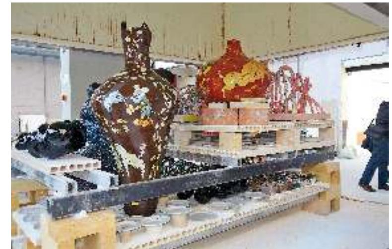
L'enfournement des pièces est le moment de tous les dangers. À l'état sec, l'argile est extrêmement friable. D'où un quasi-recueillement durant l'opération. Sur la sole mobile, la belle architecture sera toutefois montée avec, entre les pièces, des plaques réfractaires et autres éléments de stabilité.
